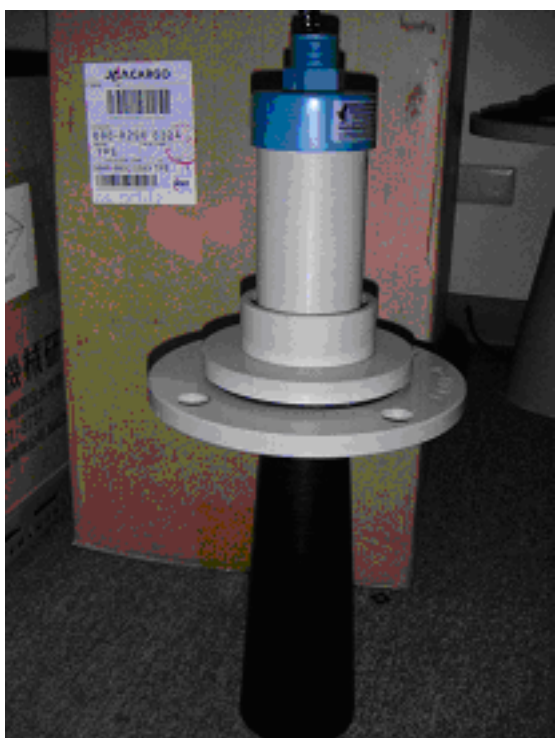
最後再套上音波發射器，旋緊螺牙
