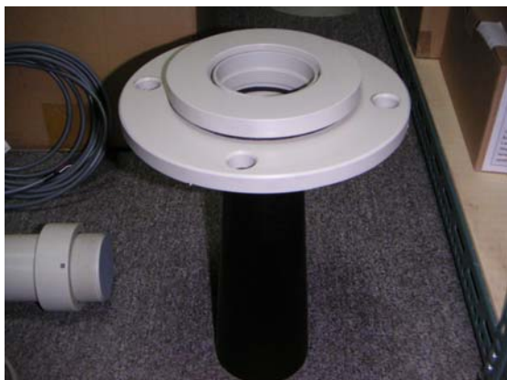
聚波管加上法蘭，將螺牙旋緊
